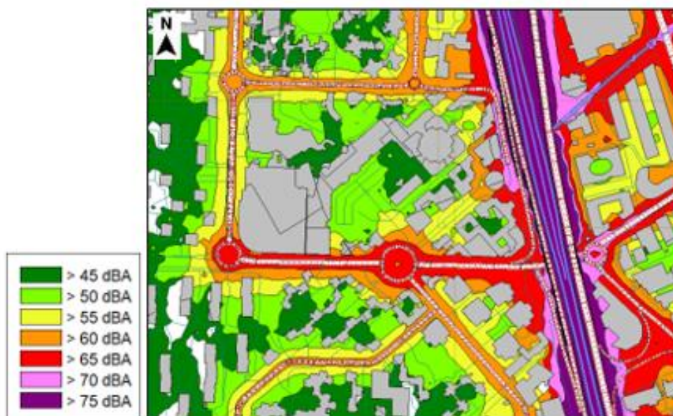
Cartographie sonore en dBA à 4m au-dessus du sol – Etat initial – Secteur Auchan-Gare – Période 6h-22h
