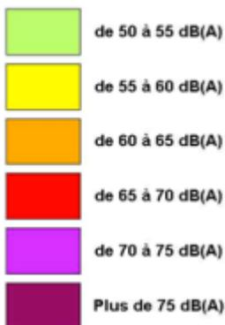
La cartographie représente des « courbes isophones » tracées de 5 en 5 dB(A) à partir de 50 dB(A) jusqu'à 75 dB(A). Les zones de bruit comprises entre les courbes isophones sont représentées par une couleur normalisée.
