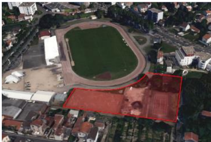
Figure 15 : Implantation possible de la centrale géothermique
