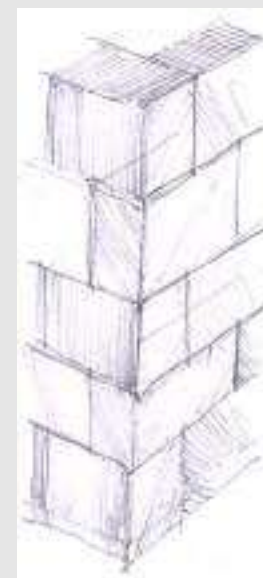
Harpage de pierres à l'angle d'un mur (chaîne d'angle)
