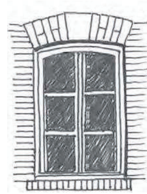
Le châssis doit épouser la forme de la baie. Ici il s'adapte au centre de la baie
