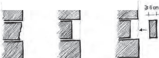
Remplacement de la partie abîmée par un placage (l'épaisseur du placage doit être supérieure ou égale à 6 cm)
