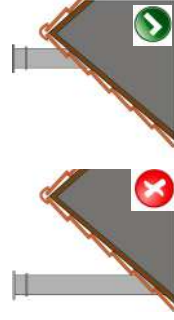
TRAVAUX INADAPTÉS : Positionner le conduit en bas de pente BONNE PRATIQUE : Positionner le conduit au plus près du faîtage pour limiter la hauteur de conduit
