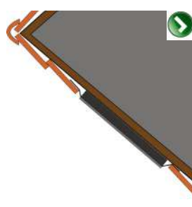
BONNES PRATIQUES : Châssis de toit intégrés dans le plan de couverture sans saillies.
