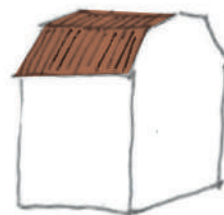
TOIT À LA MANSART
