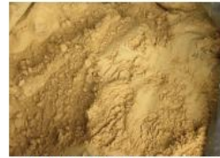
Les pigments naturels ; ocre et terre de Sienne donnent à l'enduit des nuances ocrées jaune ou rose
